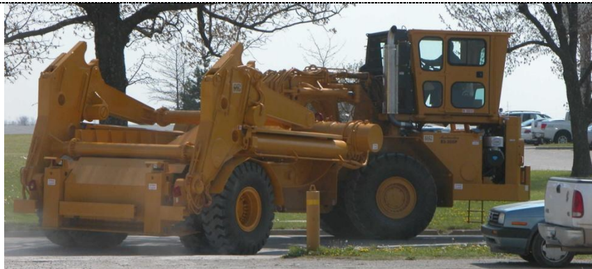
Figure 2.10. 100 ton Steel Slag Crucible Handler
